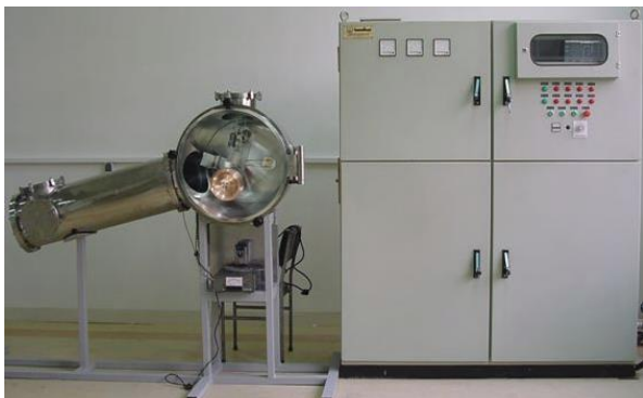
دستگاه ذوب ریسی تحت گاز محافظ مدل: MS
