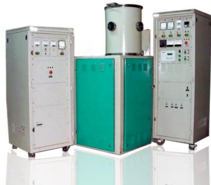
سیستم لایه‌نشانی تبخیر با پرتو الکترونی مدل: EDS و ETS
