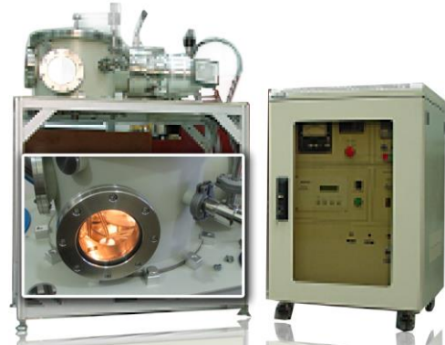
سیستم لایه‌نشانی با لیزر پالسی مدل: LTS
