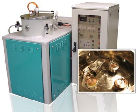
سیستم لایه‌نشانی مگنترون اسپاترینگ مدل: MSS
